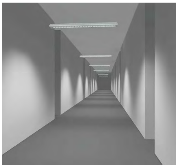
Abbildung 38: Beleuchtungssimulation der sanierten Flurbeleuchtung
