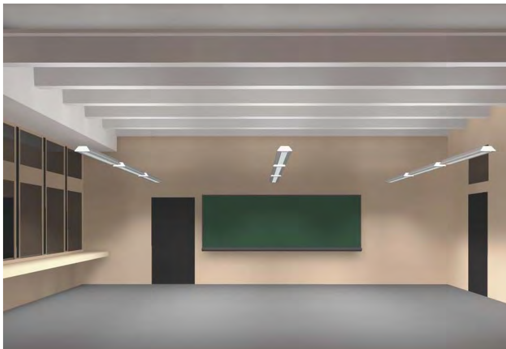
Abbildung 34: Simulation / Austausch der Leuchte durch Spiegelleuchte 1 x 55 W, T5, direkte / indirekte Beleuchtung
