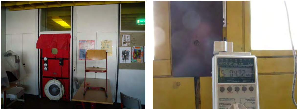
Abbildung 13: Einbau Blower-Door in Klassentür, Aufnahme lokaler Undichtheiten in der Gebäudehülle
