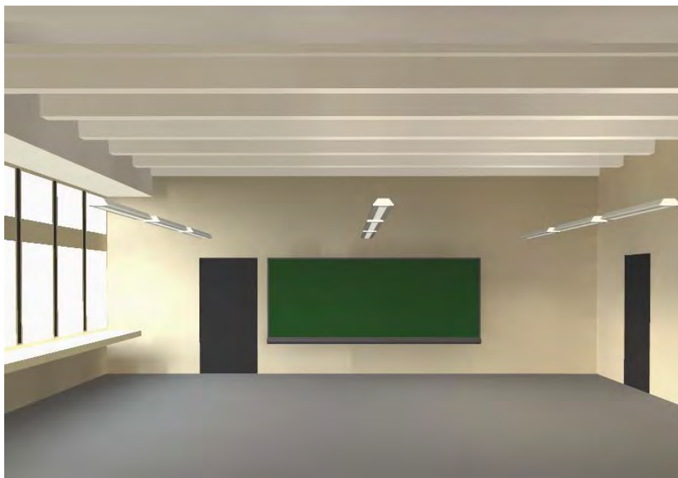
Abbildung 36: Simulation / Austausch der Leuchte durch Spiegelleuchte 1 x 35 W, T5, direkte / indirekte Lichtlenkung und zusätzliche tageslichtabhängiger Regelung mit Präsenzerkennung
